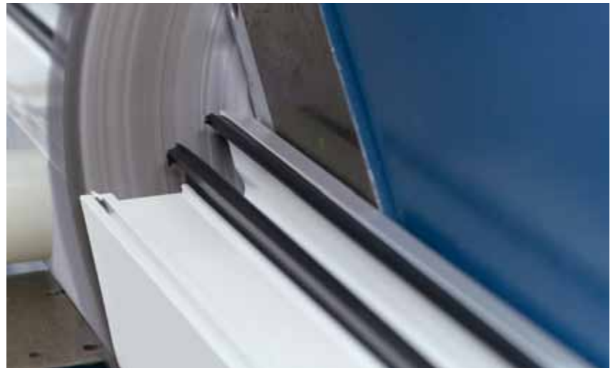
Обработка профилей из ПВХ на станке с ионизированным воздухом предотвращает прилипание стружки и пыли
