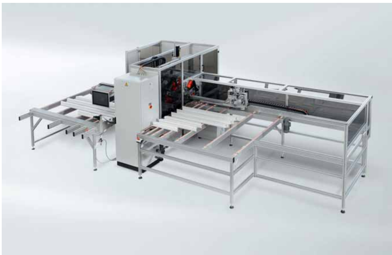
Стационарный обрабатывающий центр Schüco TH-PBZ-4 с ионизирующими форсунками
