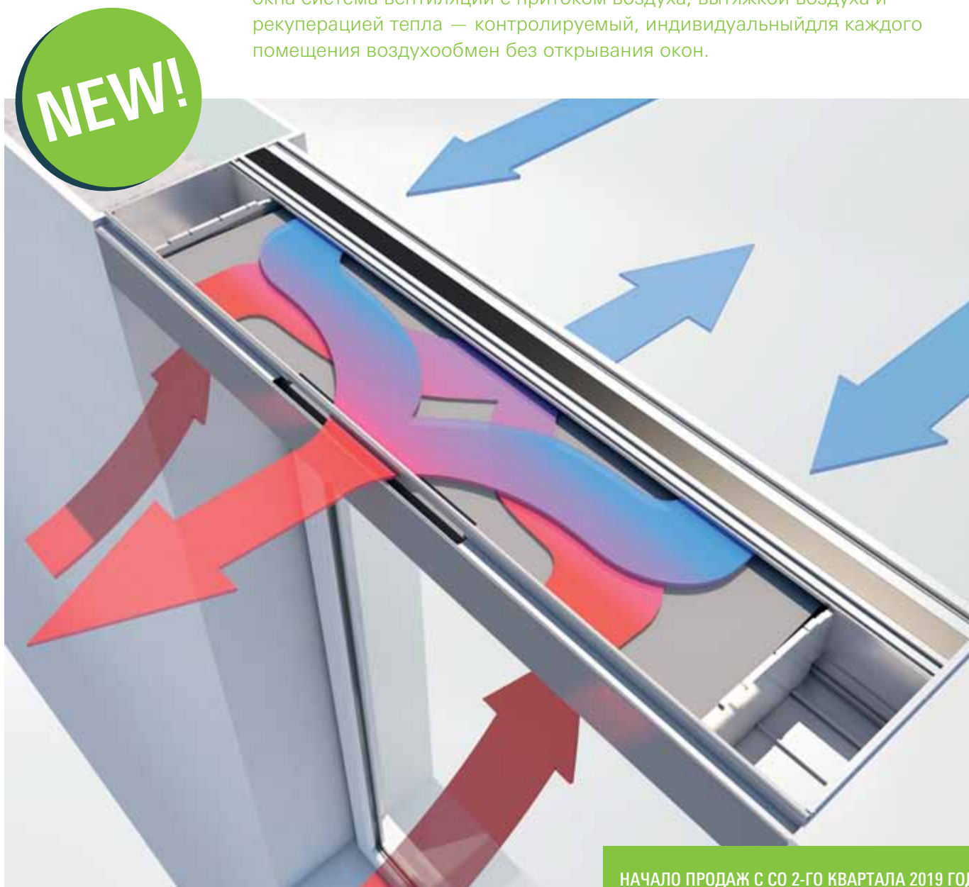
Принцип работы Schüco VentoTherm Advanced
